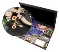
**16.** グラフィックスカードヒートシンクを所定の位置に固定するネジを外します。
