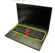
6. システム基板からキーボードデータケーブルを取り外します。
