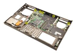
**26.** システム基板アセンブリの底の端を静かに持ち上げ、**45°**の角度に引き上げます。
