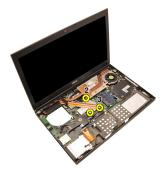
**13.** CPU ヒートシンクを持ち上げながら、コンピューターから取り出します。
