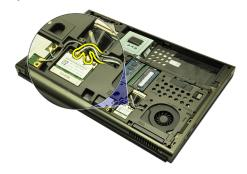
5. WLAN カードをコンピューターに固定しているネジを外します。
