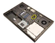
6. コンピューターからコイン型電池を取り外します。
