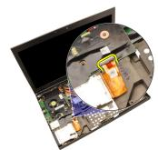
11. 入力/出力(IO) ボードを所定の位置に固定するネジを外します。
