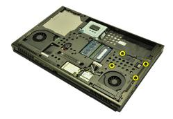
5. ハードドライブラッチを所定の位置に固定するネジを外します。
