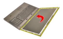
7. ディスプレイパネル背面の接着をはがし、LVDS (低電圧差動信号) ケーブルを取り外します。
