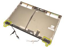
**16.** ケーブルからディスプレイヒンジタワーを解除し、ヒンジタワーを 取り外します。
