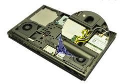
**5. WWAN** (ワイヤレスワイドエリアネットワーク) を所定の位置に固定するネジを外します。
