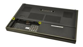
**4.** ゴムの脚をコンピューター後部に向かって押し、底のドアを取り外します。
