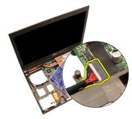
14. DC 入力ブラケットを所定の位置に固定するネジを外します。
