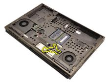
12. コンピューターの底部のネジを外します。
