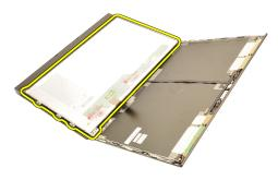
**9.** ディスプレイブラケットをディスプレイパネルに固定するネジを外します。
