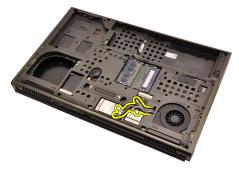
14. コンピューターのトップにある穴からアンテナを取り出します。
