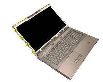
5. ディスプレイパネルを所定の位置に固定するネジを外します。
