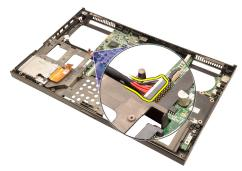
25. システム基板を所定の位置に固定するネジを外します。
