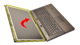
7. ディスプレイパネル背面の接着をはがし、LVDS (低電圧差動信号) ケーブルを取り外します。
