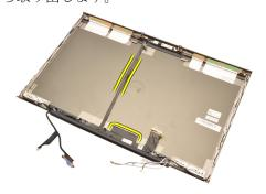
**16.** 配線チャンネルから LDVS ケーブルを取り外します。
