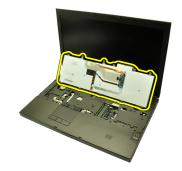
**8.** キーボードデータケーブルをキーボードの背面に固定する接着テープをはがします。
