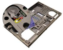
**23.** システム基板の上部にあるワイヤレススイッチケーブルを取り外します。
