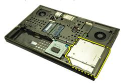
**6.** オプティカルドライブブラケットを所定の位置に固定するネジを外します。
