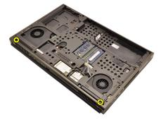
13. コンピューターの後部のネジを外します。
