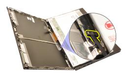
9. デジタイザーを所定の位置に固定するネジを外します。
