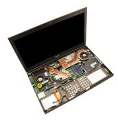
**12.** 10 ボードの左端を持ち上げ、コネクターを外してから、コンピューターから取り外します。
