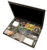
**18.** グラフィックスカードヒートシンクを持ち上げながら、コンピューターから取り出します。
