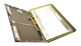
**11.** ディスプレイブラケットをディスプレイパネルに固定するネジを外します。
