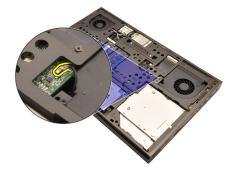
5. CPU ファンを所定の位置に固定するネジを外します。
