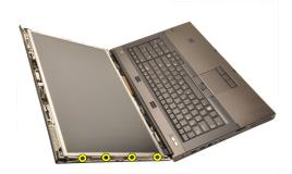
**5.** ディスプレイパネルを所定の位置に固定する右側のネジを外します。
