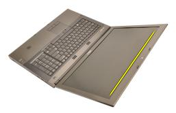
**4.** ディスプレイベゼルの底部の端と両側も同じように持ち上げ、ディスプレイベゼルを取り外します。
