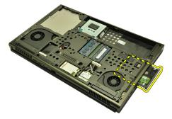
**8.** ハードドライブブラケットを外側に曲げ、ハードドライブを底から上に押し上げます。
