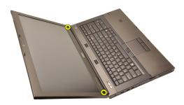
4. ディスプレイパネルを所定の位置に固定するネジを外します。
