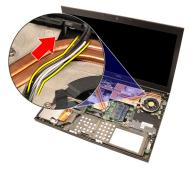
**15. LVDS** (低電圧差動信号) ケーブルを所定の位置に固定する拘束ネジを緩めます。
