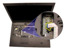
**15.** RFID(Radio Frequency Identification)ケーブルを取り外します。
